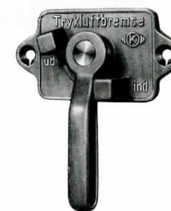
Fig. 13. Omstilling ind — ud for trykluftbremsen
