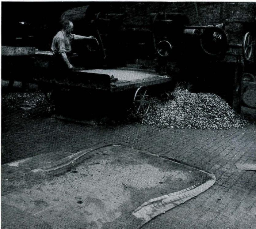
Abb. 4. Fräsmaschine in Sonderbauart. Vorn eine gefräste Rohrwand mit sich verjüngenden Rändern
