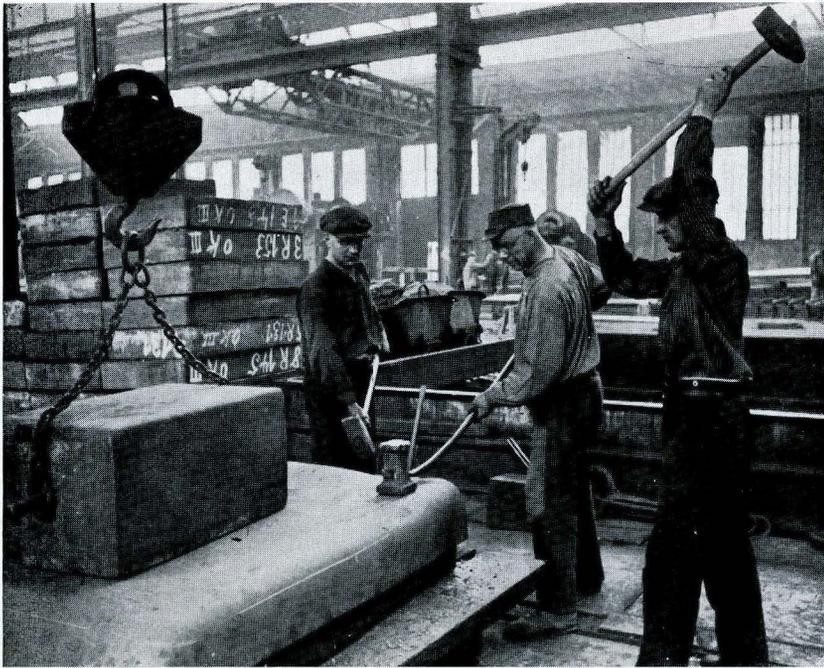
Abb. 6. Nachrichten einer gekümpelten Rohrwand
