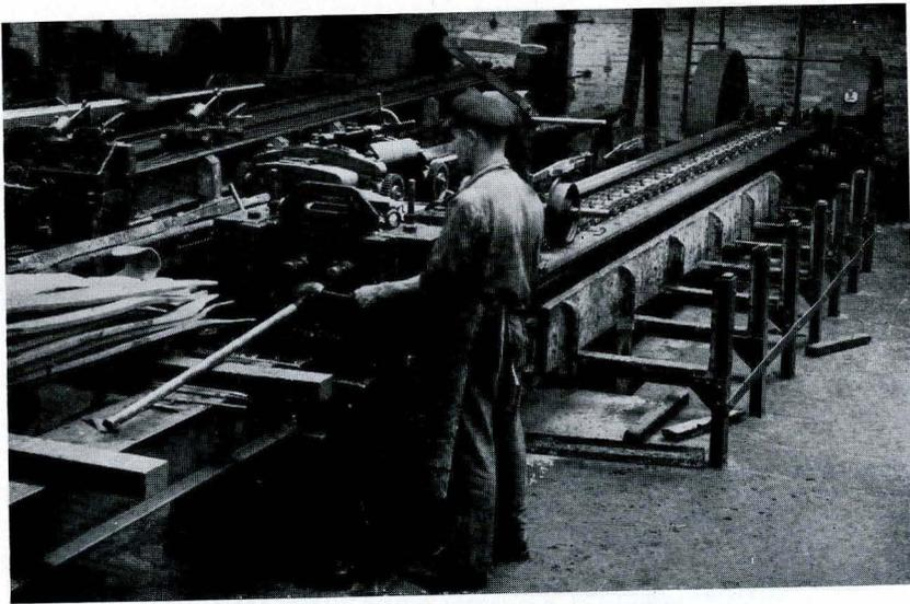
Abb. 14. Herstellen der Stehbolzen-Stangen durch Kaltziehen
