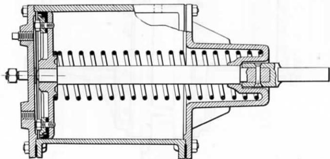
FIG. 208.—BRAKE CYLINDER, HORIZONTAL TYPE.
