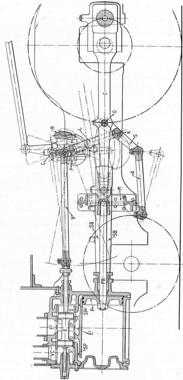
FIG. 92.—LAYOUT OF JOY'S RADIAL VALVE MOTION FOR LOCOMOTIVES.
