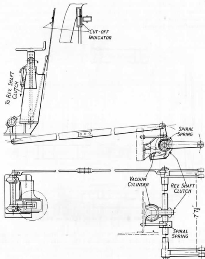
FIG. 95.—SCREW REVERSING GEAR OF L.N.E.R. 4-6-2 EXPRESS LOCOMOTIVE.
