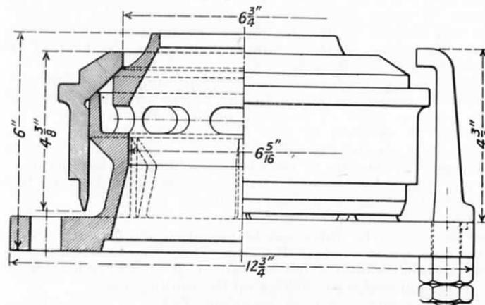
FIG. 45.—AUTOMATIC "JUMPER" BLAST-PIPE TOP, G.W.R.
