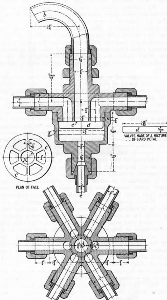
FIG. 116.—FURTHER DETAILS OF SPENCER'S CYLINDER RELIEF VALVES.
