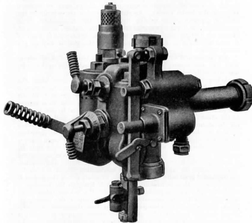
FIG. 194.—METCALFE VACUUM BRAKE EJECTOR FITTED WITH STEAM BRAKE VALVE.
