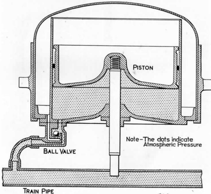
FIG. 182.—AUTOMATIC VACUUM BRAKE, "ON."
