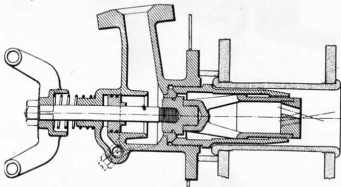
FIG. 20.—DETAILS OF DIAMOND SOOT BLOWER FOR LOCOMOTIVE BOILERS.
