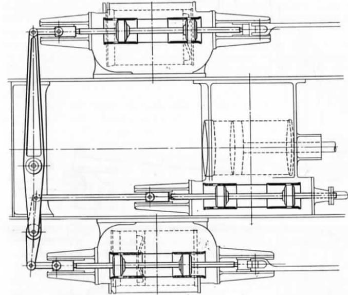
FIG. 94.—THE GRESLEY VALVE GEAR IN PLAN.
