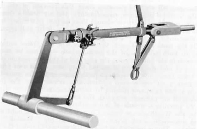
FIG. 211.—"WESLAK" SLACK ADJUSTER BEFORE RESETTING.
