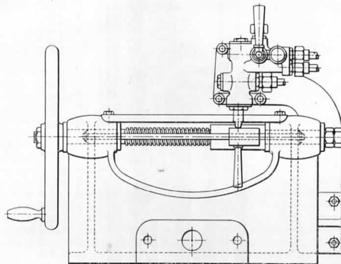
FIG. 269.—TYPICAL BOOSTER CONTROL LATCH ARRANGEMENT AS USED WITH SCREW REVERSING GEAR.
