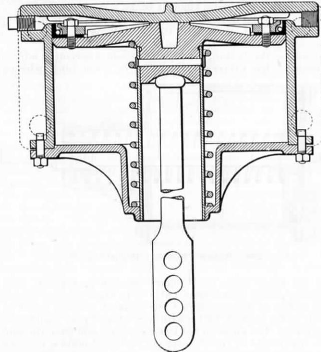
FIG. 207.—BRAKE CYLINDER, VERTICAL TYPE.
