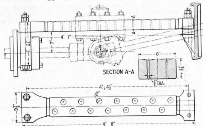
FIG. 126.—CROSSHEAD FOR SINGLE SLIDE BAR.
