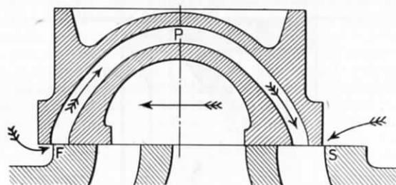
FIG. 100.—LOCOMOTIVE SLIDE VALVE
