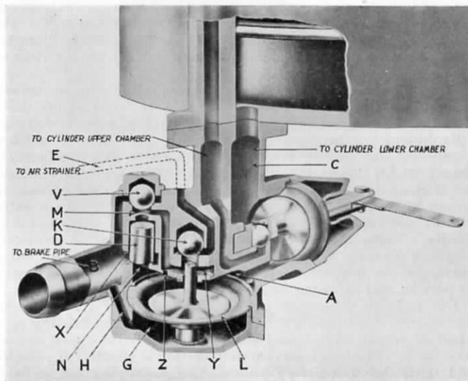
FIG. 190.—WESTINGHOUSE QUICK-SERVICE BRAKE APPLICATION VALVE SHOWN IN SECTION.
