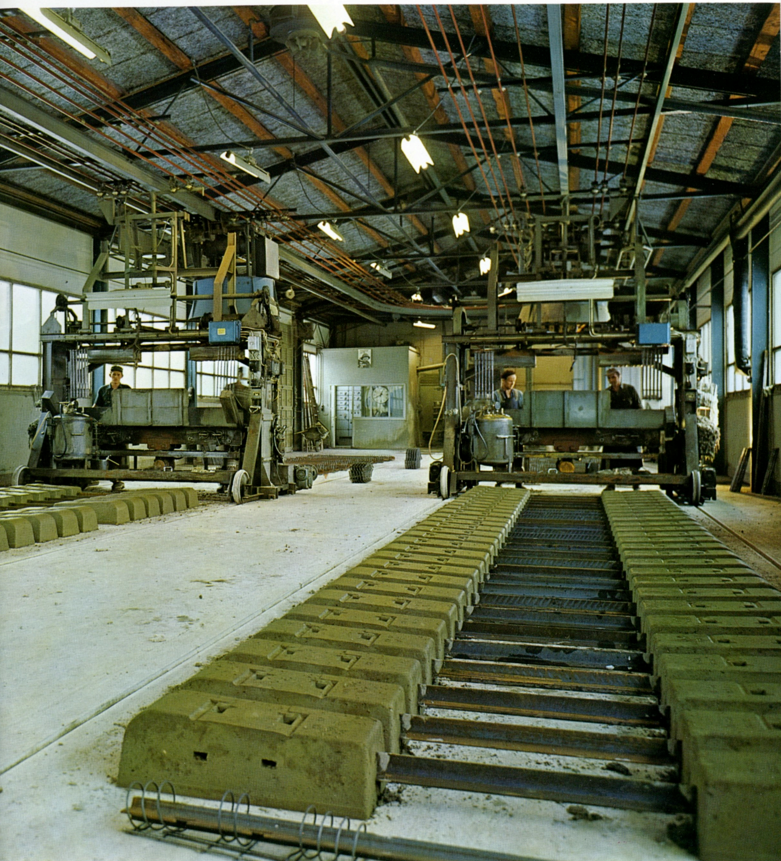
De mange betonsveller, der anvendes ved statsbanerne, fremstilles rent industrielt på en fabrik, der er bygget i Fredericia efter en aftale med et privat firma.
