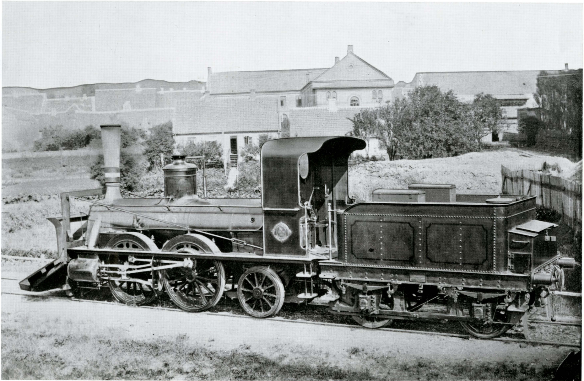
Jydsk sidebanelokomotiv litra L. Bygget 1877 i Tyskland (Hannover). Vægt 15,5 + 10. Kedeltryk 8,5 atm. Rist 0,9 m 2 . Cylindre 305 × 508. Drivhjul 1372. Oprindelig anskaffet til Aarhus—Grenaa-banen. Senere ombygget til tenderlokomotiv til rangertjeneste.
