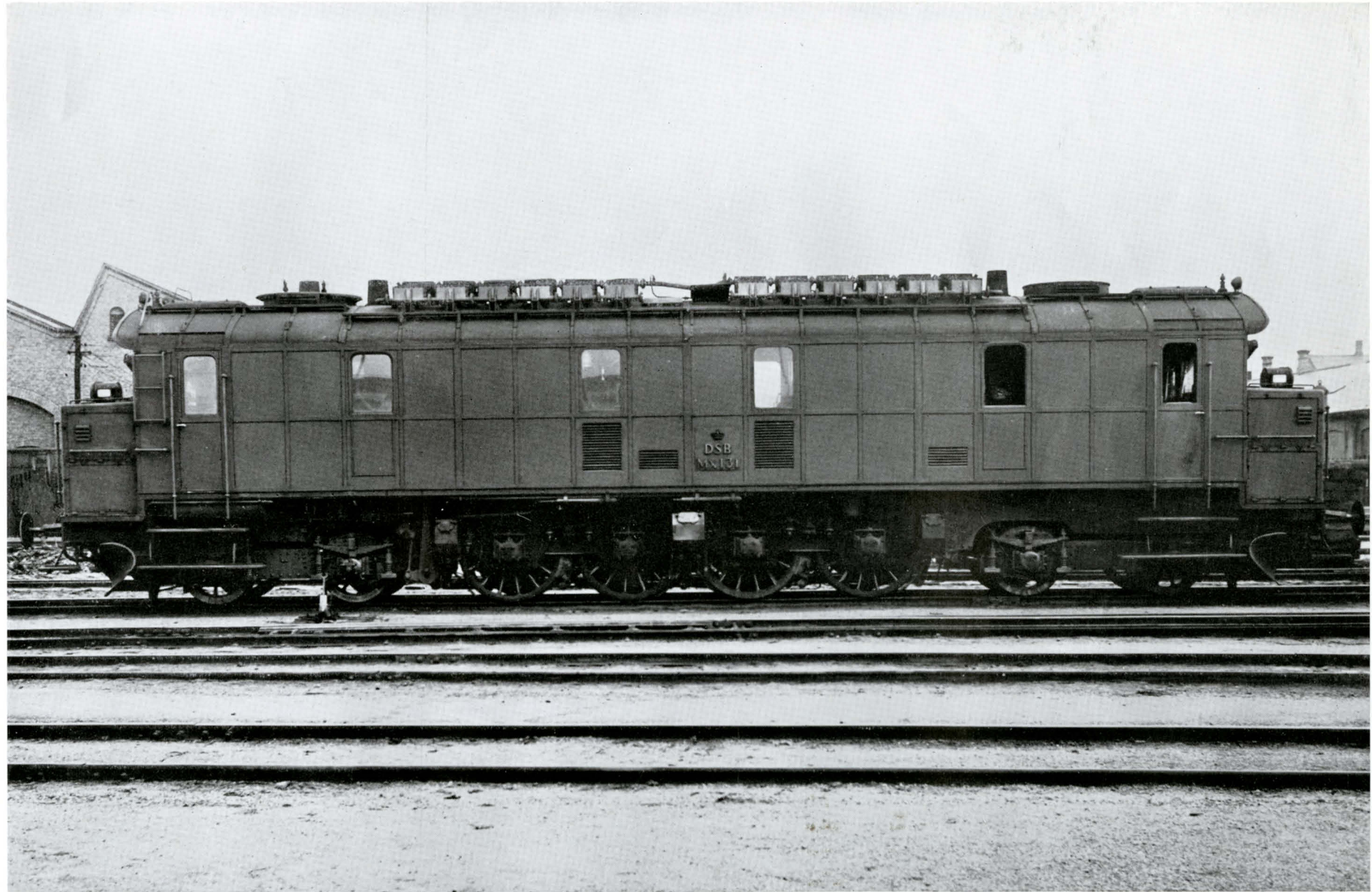
Diselelektrisk lokomotiv litra MX. Nr. 131—132 bygget af A/S Frichs, Aarhus. Vægt 103. Max. togvægt 350. Max. hastighed 100 km/t. Lokomotivet er forsynet med to 6 cyl. Frichs-dieselmotorer, der hver udvikler 450 HK ved 600 O/M. Maskinerne er hver for sig direkte koblet til en dynamo. Dynamoerne leverer strøm til 4 banemotorer, der gennem en tandhjulsvudveksling trækker drivhjulene. Der findes trykluftbremse samt en oliefyret dampkedel til togopvarmning. Lokomotivet kan anvendes til persontog, hurtige tog og godstog.
