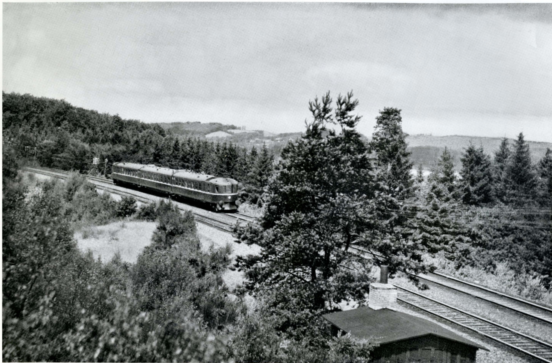
Dieselektrisk 3-vogns lyntog litra MS/AA/MS. MS nr. 401—406 og AA nr. 431—433 er byggede 1935 af A/S Frichs, Aarhus, og A/S Scandia, Randers. Samlet vægt 136. Max. hastighed 120 km/t. MS vognen hviler på en 2-akslet maskinbogie med to 6 cyl. dieselmotorer af Mo typen, der hver udvikler 250 HK ved 1000 O/M, og er direkte koblet til en dynamo, samt en 2-akslet banemotorbogie (med 2 banemotorer), der er fælles med AA vognen. I et 3-vogns lyntog findes ialt 36 1. kl. og 132 fælleskl. siddepladser, et rejsegodsrum til 1,3 ton gods, en bar, 3 toiletter og 2 førerrum, 2 varmtvandskedler (koks) til opvarmning af toget, trykluftbremse og elektromagnetisk skinnebremse. Togene, der er indrettet til at overføres med Storebæltsfærgerne, benyttes særlig til fremførelse af lyntog. Der blev oprindeligt lavet 4 stk. 3-vogns lyntog, men 1 stk. er senere ombygget til 4-vogns lyntog.
