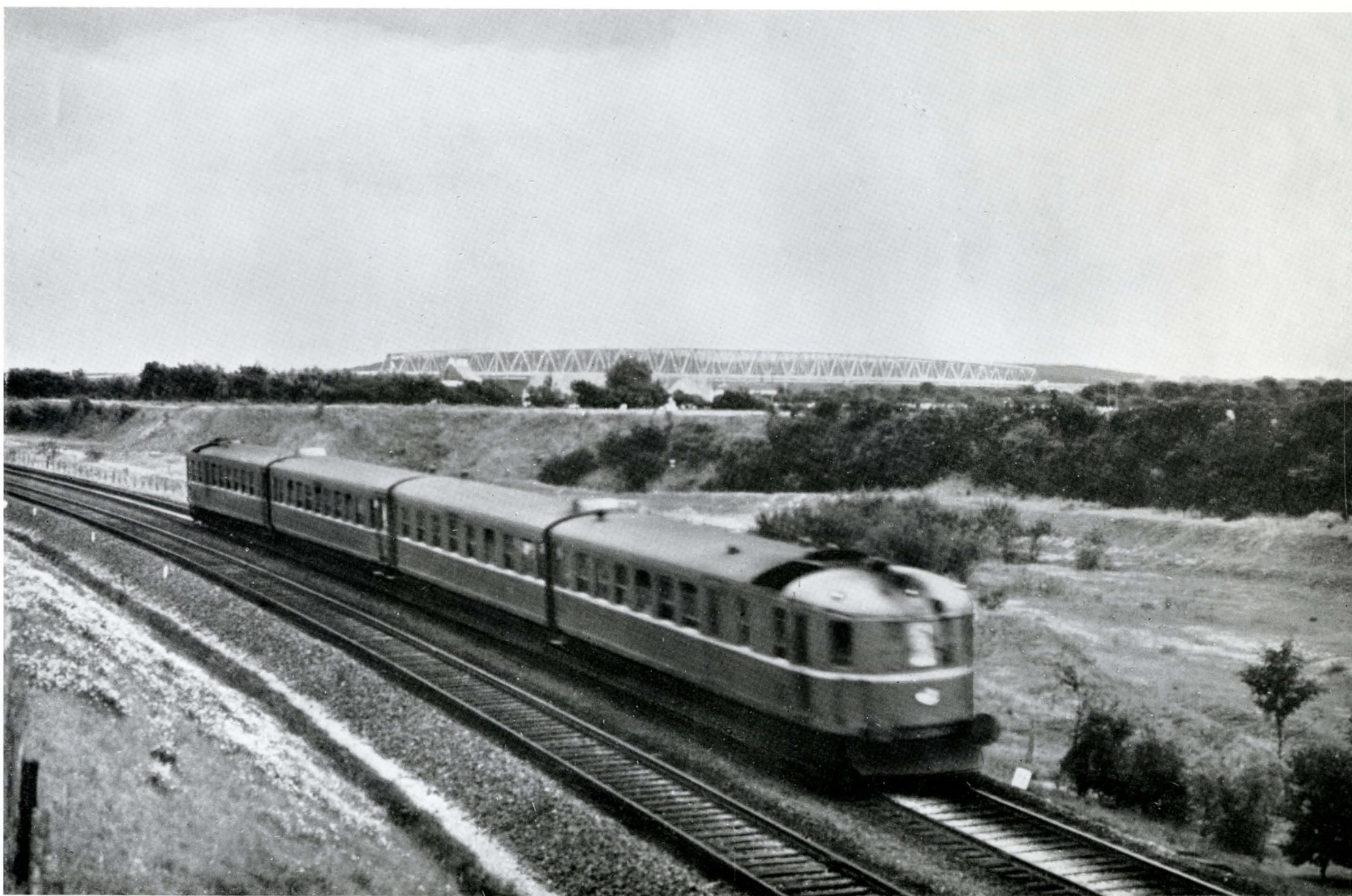
Dieselektrisk 4-vogns lyntog litra MB/AB/FJ/MB. MB nr. 407—416, AB nr. 434—438, FJ nr. 446—450 er bygget 1937 af A/S Frichs, Aarhus, og A/S Scandia, Randers. Samlet Vægt 190. Max. hastighed 120 km/t. MB vognen hviler på en 2-akslet maskinbogie med to 6 cyl. dieselmotorer af Mo typen, der hver udvikler 250 HK ved 1000 O/M, og er direkte koblet til en dynamo, samt en 2-akslet banemotorbogie (med 2 banemotorer), der er fælles med AB eller FJ vognen. I et 4-vogns lyntog findes ialt 42 1. kl. og 180 fælleskl. siddepladser, et rejsegodsrum til 1,7 ton gods, en bar, 4 toiletter og to førerrum. 2 varmtvandskedler til opvarmning af toget, trykluftbremse og elektromagnetisk skinnebremse. Togene, der er indrettet til at overføres med Storebæltfærgerne, benyttes særlig til fremførsel af lyntog. Der blev oprindeligt leveret 4 stk. 4-vogns lyntog, senere er et 3-vogns lyntog ombygget til 4-vogns lyntog.
