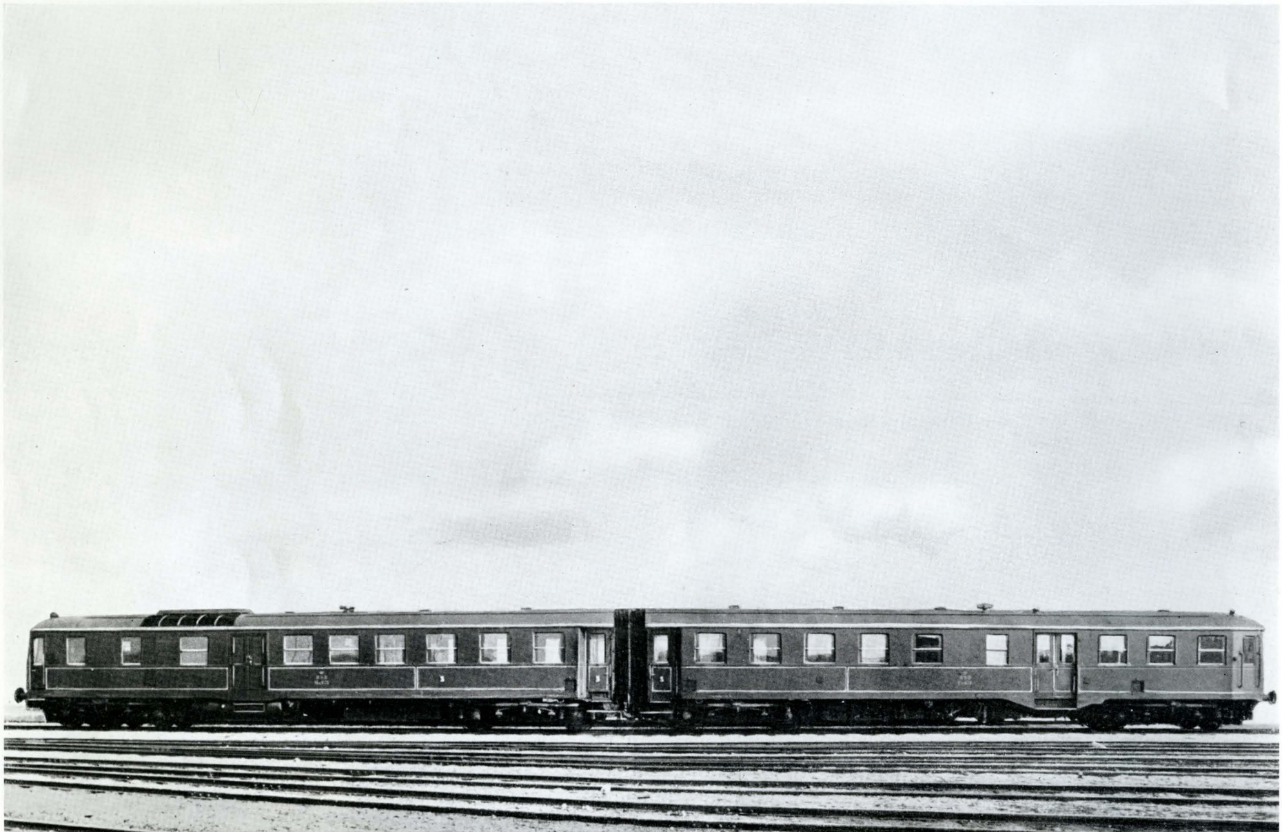
Diselelektrisk motortog litra MK/FK. Nr. 675—676 bygget 1943 og nr. 679—680, 681—682, 684—684, 685—686 bygget 1951 af A/S Frichs, Aarhus, og A/S Scandia, Randers. Vægt 128. Max. togvægt 368. Max. toghastighed 120 km/t. MK vognen har en 3-akslet maskinbogie med to 8 cyl. trykladede dieselmotorer af Mo typen, der hver udvikler 500 HK ved 1000 O/M og er direkte koblet til en dynamo, samt en 2-akslet banemotorbogie med 2 banemotorer. FK vognen hviler på to 2-akslede banemotorbogier, der hver har to banemotorer. Der findes i begge vogne tilsammen 110 siddepladser, 2 førerrum, et rejsegodsrum til 1,6 ton gods, 2 toiletter, en automatisk oliefyret dampkedel til togopvarmning, trykluftbremse. Vognen er konstrueret til såvel hurtige tog (Englænderen) som standsende persontog.
