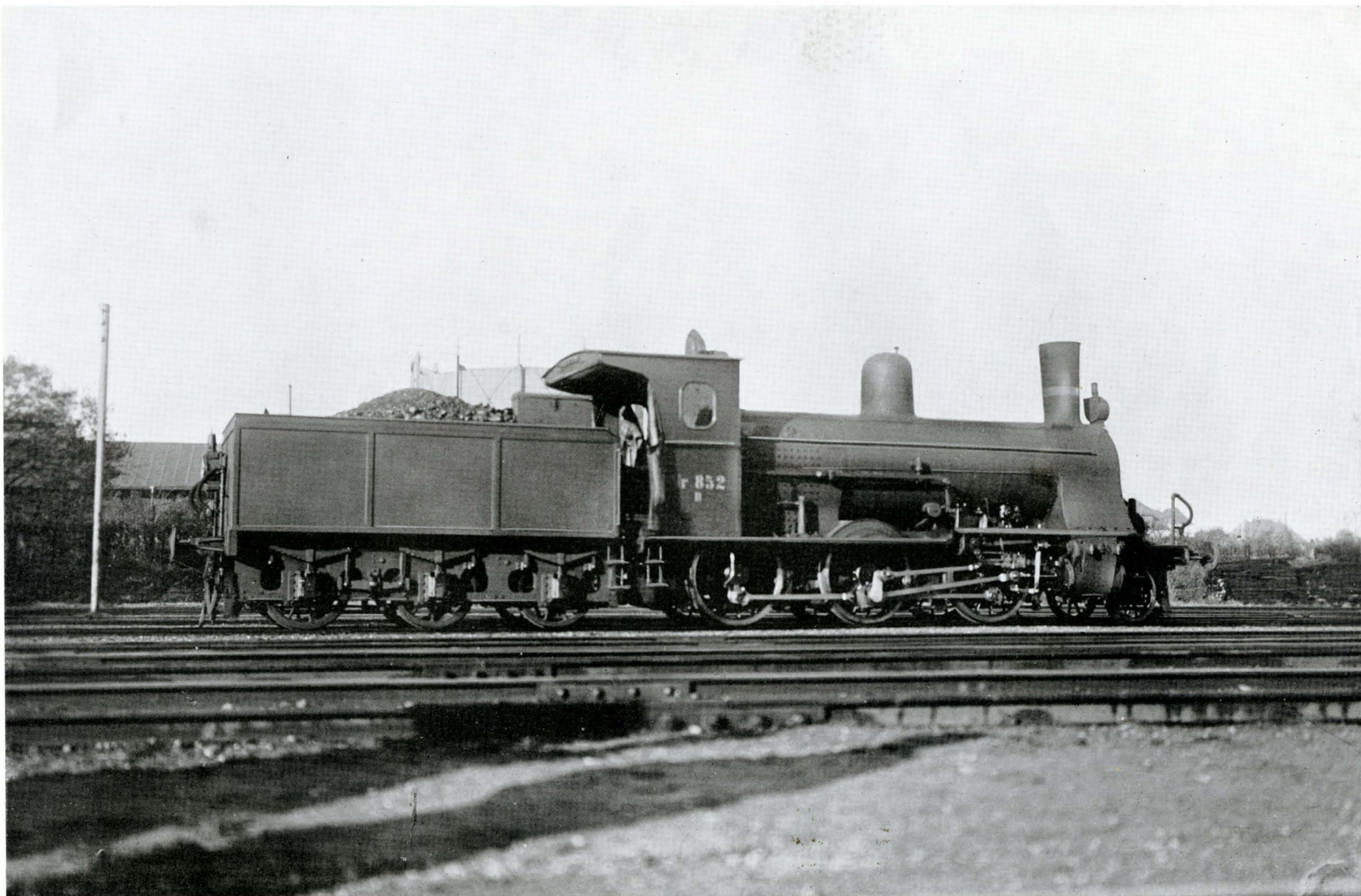
Godstogslokomotiv litra D. — Maskinerne er byggede i flere serier; de første leveredes i 1902, de sidste i 1922. Er byggede i Tyskland, Sverige, Belgien, USA, de sidste 5 af Frichs i Aarhus. De første lokomotiver var mættedamplokomotiver, men forsynedes senere med overheder; de senere leveredes med overheder. Vægt og dimensioner noget varierende fra serie til serie. De sidste, 896—900, har vægt 44 + 28. Kedeltryk 12 atm. Rist 1,8 m 2 . Cylindre 460 × 610. Drivhjul 1404. Maksimalhastighed 70 km/t. Trækkeevne: godstog på 600 tons med 40 km's fart på vandret bane. Antal D-maskiner ialt: 100 stk.
