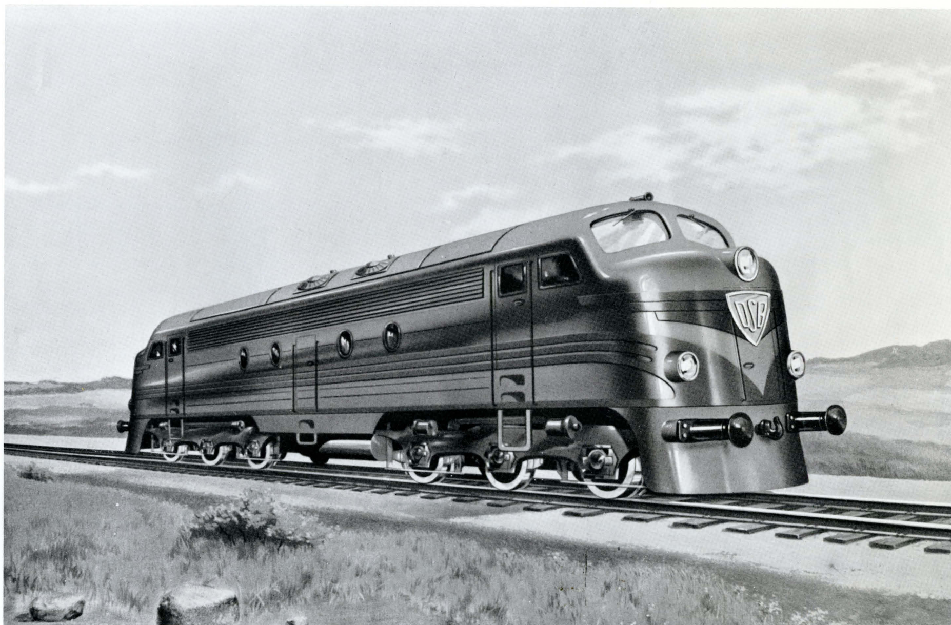
Dieselektrisk lokomotiv litra MY. Nr. 1101—1104. Under bygning af Nydqvist & Holm, Trollhättan, General Motors, U. S. A., og A/S Frichs, Aarhus. Vægt 103. Max. togvægt 1000. Max. hastighed 120 km/t. Lokomotivet er forsynet med en 16 cyl. V-formet 2-takts General Motors-dieselmotor, der udvikler ca. 1500 HK ved 800 O/M. Motoren er direkte koblet til en dynamo. Lokomotivet hviler på to 3-akslede bogier, der hver er forsynet med 2 banemotorer. Der er trykluftbremse og automatisk oliefyret dampkedel til togopvarmning. Lokomotivet er et universallokomotiv, der kan fremføre både hurtigtog, standsende persontog og godstog.
