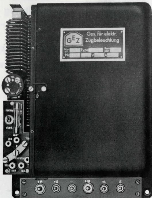
Bild 2: Reglergerät ZR 50s, linke Schutzkappe abgenommen
