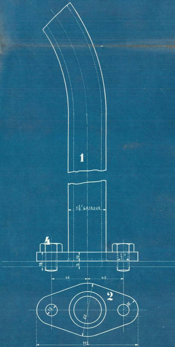
Luftrohr auf dem Wasserkasten.
