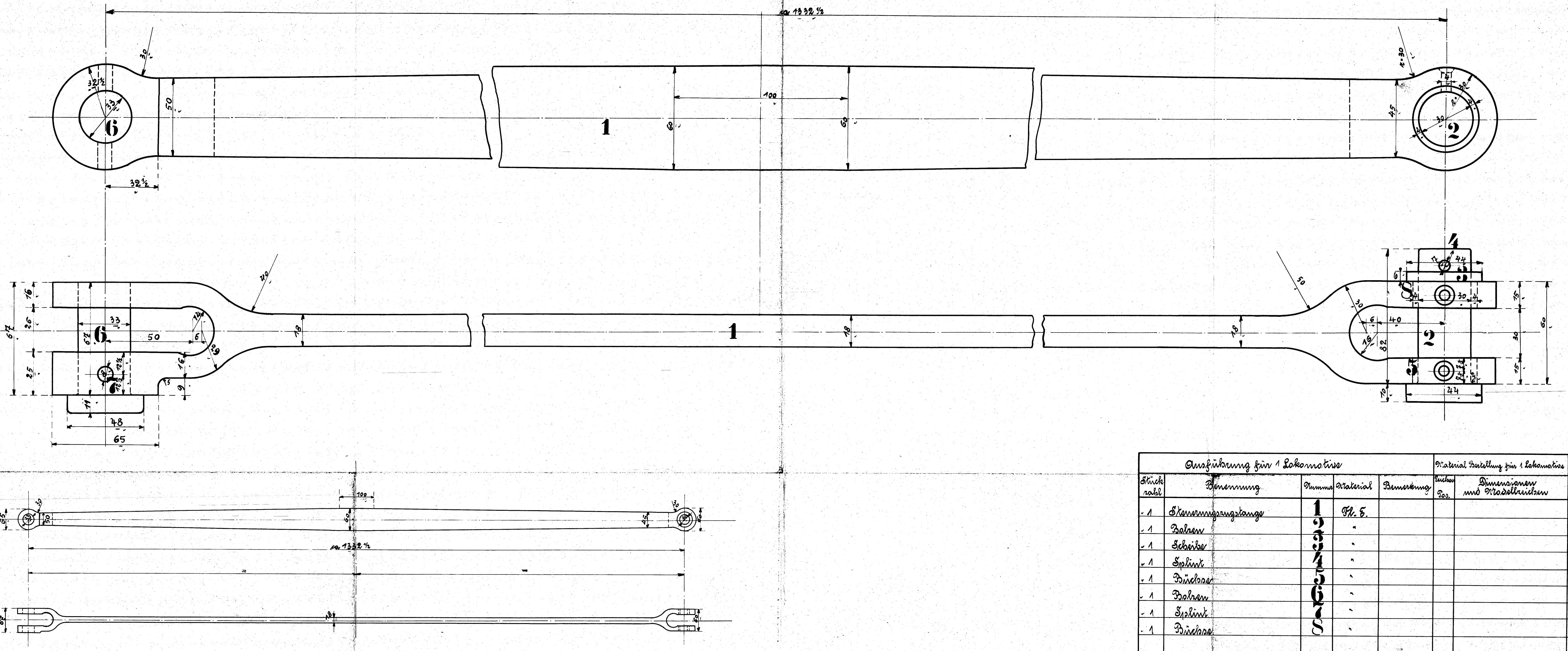
Augen, Löcher und Büchsen durch Einschmelzen härtet.
