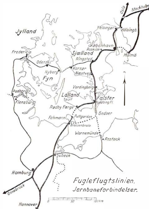
Fig. 1. De viste stationer – med undtagelse af Vordingborg, Nykøbing F, Gedser og Rødby (overgangsstationer) – betjenes fra fjernstyringscentralen i Nykøbing F.
