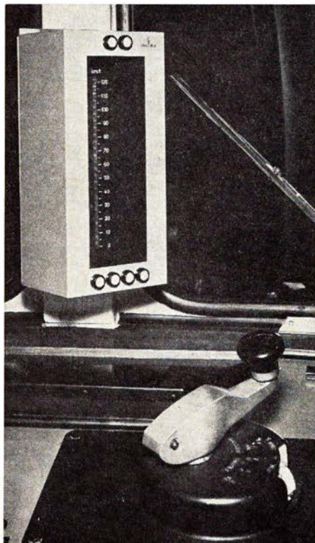
Førerrummet med det elektroniske speedometer i øjenhøjde. Håndtaget med den sorte knap indeholder den såkaldte dødmanskontakt.
