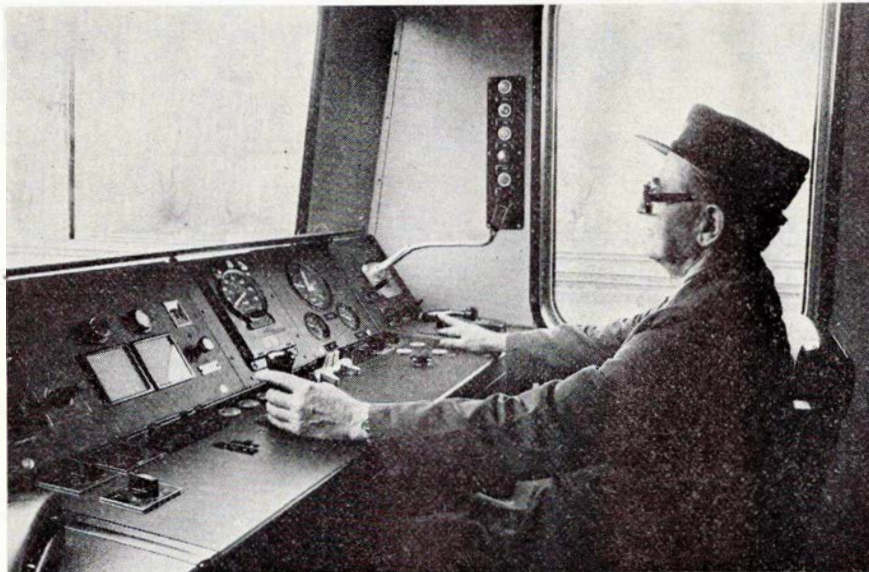
MR-togets moderne førerrum er udformet efter de nyeste principper og giver føreren af toget god udsigt gennem de store panoramavinduer. Foto: DSB.
