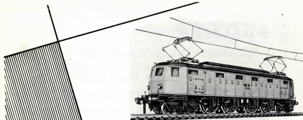
Italiensk type hurtigtogslok litra E 428 (koblet 2' D 2')
