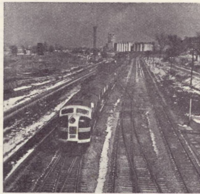
I året 1941 lod Santa Fé-banen bygge det første diesel-elektriske godstog i USA på 8400 hk. Baltimore & Ohio-jernbanen lod i 1942 bygge et tilsvarende. Hvert lokomotiv bestod af 4 enheder, hver med to stk. 2-akslede bogier. Det havde en totallængde på 59,5 m og en max.-hastighed af 112 km/tim. Med et prøvetog mellem Chicago og Twin Oakes, en strækning på 1466 km, trak dette tog 8300 t og foretog kun 5 standsninger for personaleafløsning
